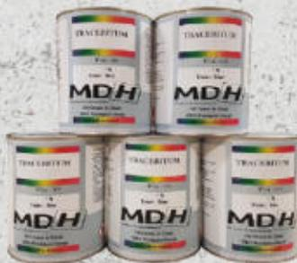
Peinture routière acrylique aspect mat mono composant 1 Kg ou 5 Kg conçue pour les axes routiers, temps de séchage très court moins de 5 minutes au toucher et 30 minutes à la remise en circulation. Traçage sur enrobé extérieur fort pouvoir couvrant.
